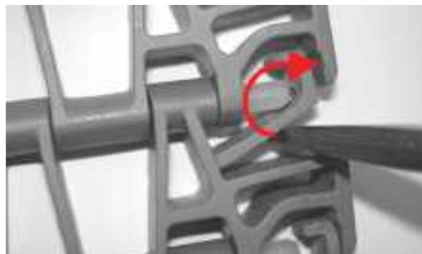
**Figure 237:** Tournez le tournevis pour maintenir le système de rétention en position ouverte
