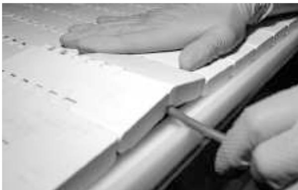
**Figure 83:** Pliez légèrement l'axe et insérez-le dans les charnières
