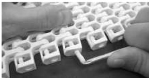
**Figure 276:** insérez l'axe dans le système de rétention
