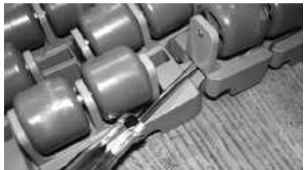
Figure 187: Introduisez le tournevis sous le rouleau
