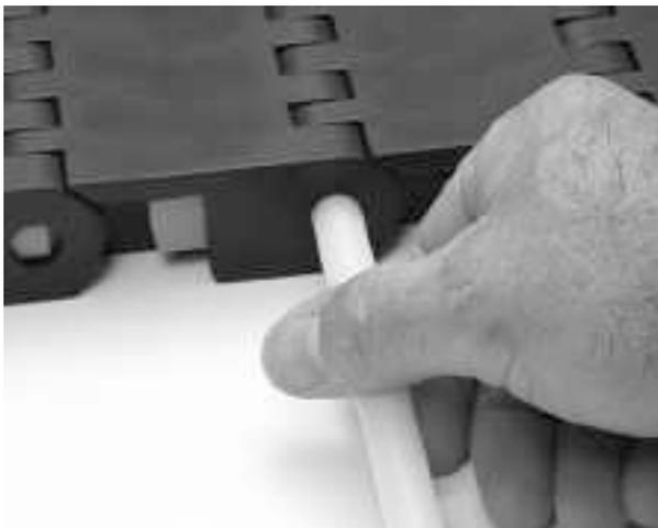
**Figure 249:** Insérez l'axe
