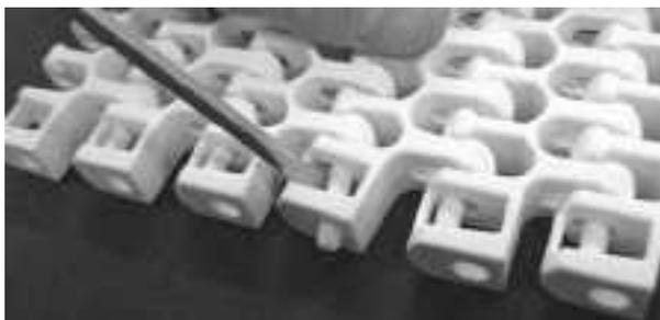
**Figure 278:** Poussez l'axe dans le système de rétention
