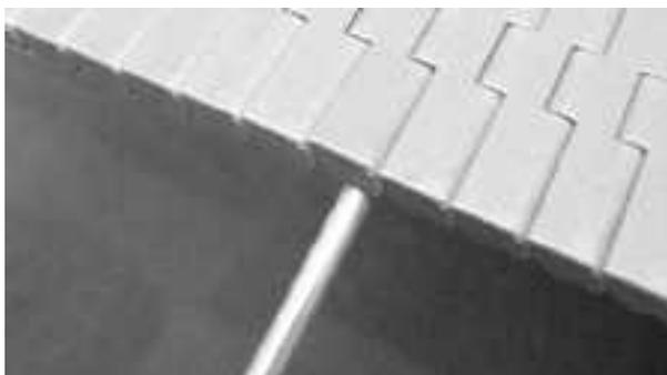
**Figure 53:** Insérez l'axe
