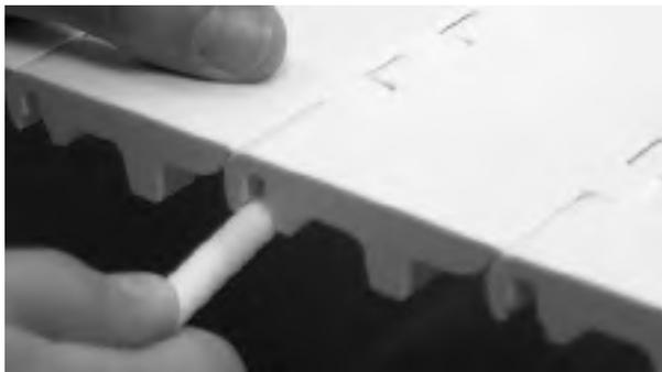
**Figure 198:** Insérez l'axe à travers les charnières
