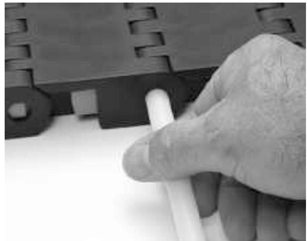
**Figure 246:** Insérez l'axe
