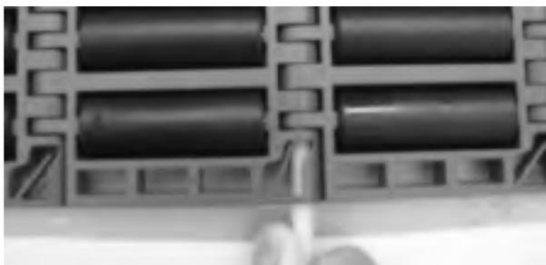
**Figure 224:** Insertion de l'axe à travers les charnières
