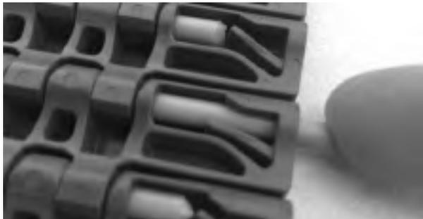
**Figure 122:** Insérez l'axe à travers les charnières
