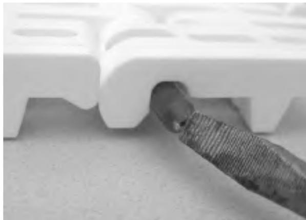
**Figure 75:** insérez l'axe dans le système de rétention
