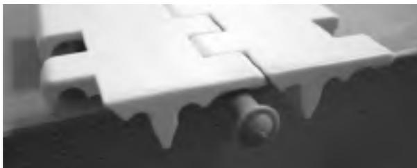
**Figure 173:** Insertion de l'axe à travers les charnières
