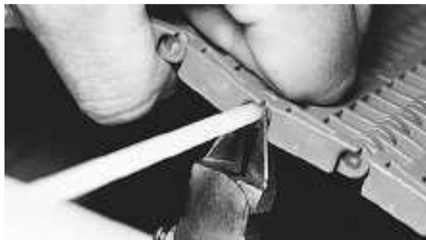
Figure 108: Coupez l'extrémité de l'axe en alignement avec le bord du tapis
