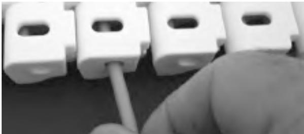
**Figure 270:** Insérez l'axe à travers les charnières
