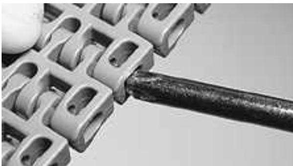
**Figure 140:** insérez l'axe dans le système de rétention
