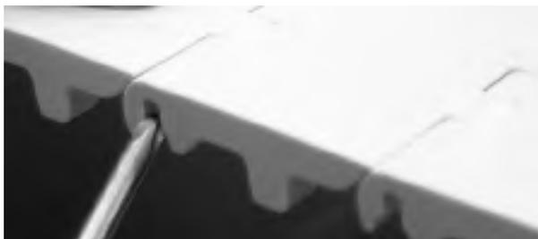
**Figure 199:** Insérez l'axe au-delà du système de rétention
