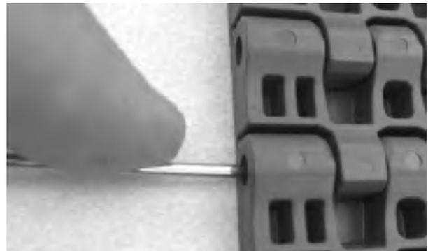
**Figure 125:** Enfoncez l'axe au-delà du bord du tapis
