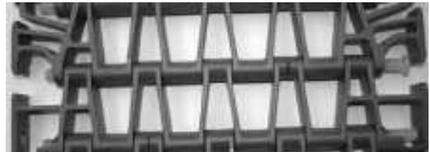
**Figure 243:** Vérifiez que l'axe est inséré au-delà du système de rétention
