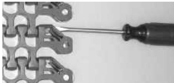
Figure 268: Système de rétention en position ouverte
