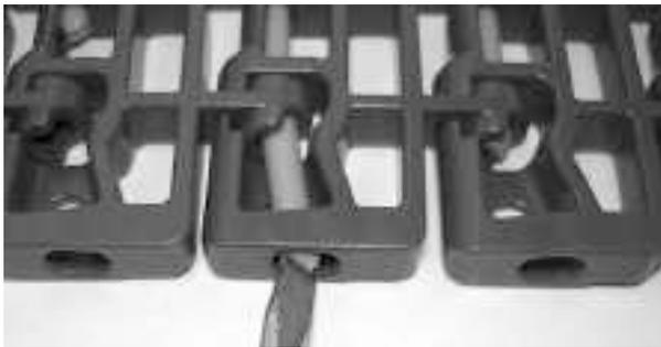
**Figure 118:** insérez l'axe dans le système de rétention
