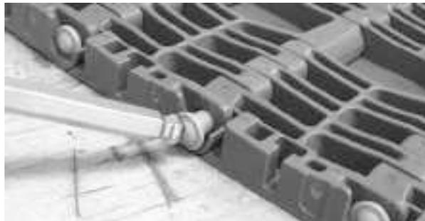
**Figure 255:** Enfoncez le petit axe au-delà du système de rétention
