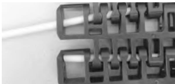
**Figure 342:** Insérez l'axe à travers les charnières
