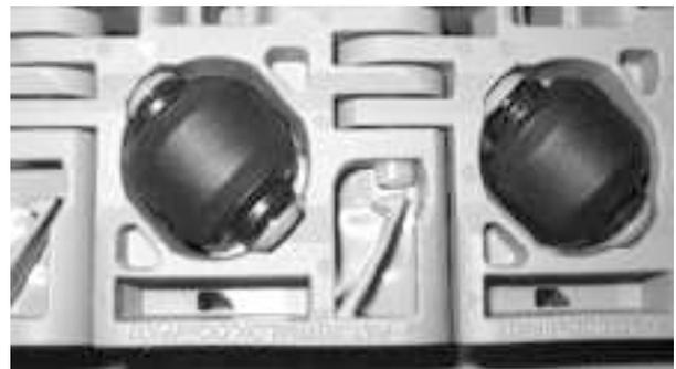
**Figure 214:** Vérifiez que l'axe est inséré au-delà du système de rétention
