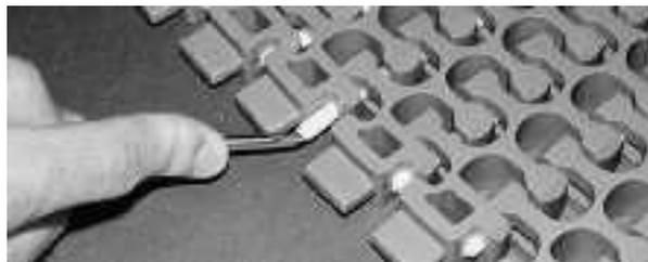
Figure 259: Vérifiez que l'axe est inséré au-delà du système de rétention
