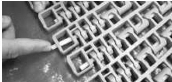
Figure 326: insérez l'axe dans le système de rétention
