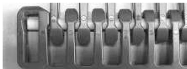
Figure 320: Vérifiez que l'axe est inséré au-delà du système de rétention
