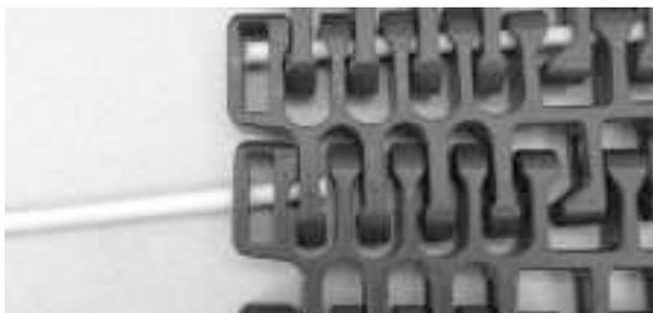
**Figure 301:** Insérez l'axe
