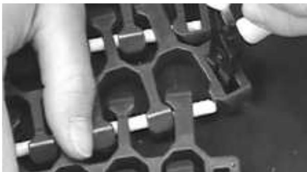
**Figure 298:** Pliez le bord lisse du module pour libérer l'axe
