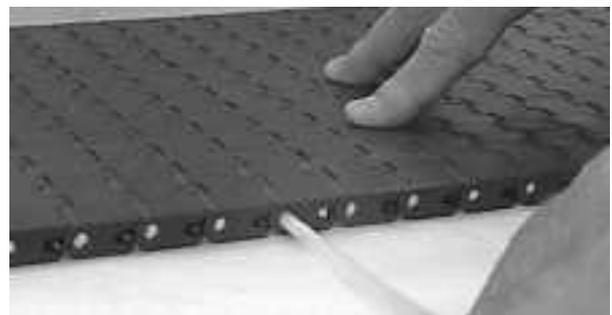
Figure 156: Insérez l'axe
