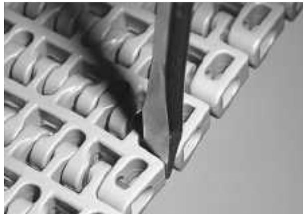
**Figure 133:** insérez l'axe dans le système de rétention
