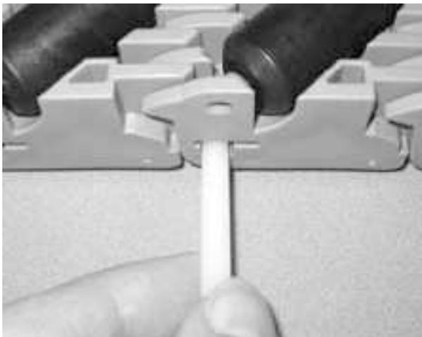
**Figure 212:** Insérez l'axe à travers les charnières
