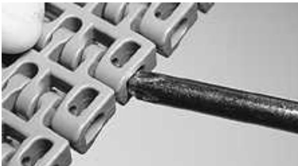
**Figure 131:** insérez l'axe dans le système de rétention
