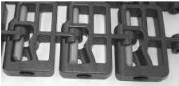
**Figure 112:** L'axe s'étend sur le bord lisse
