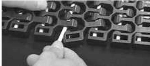
Figure 294: Insérez l'axe à travers les charnières
