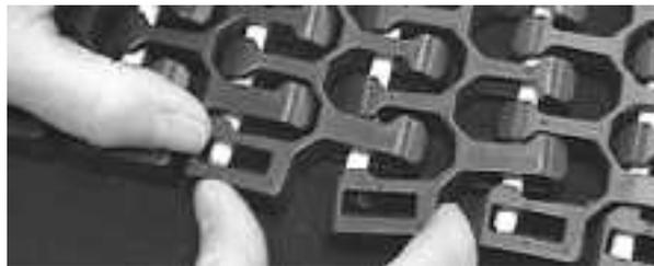
Figure 295: Enfoncez l'axe au-delà du bord du tapis et encliquez le bord lisse sur l'axe
