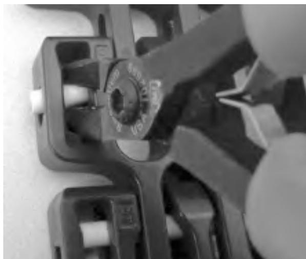
**Figure 304:** Enfoncez l'axe de biais et au-delà du trou
