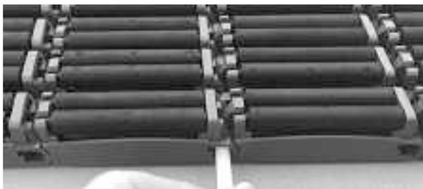
**Figure 228:** Insérez l'axe à travers les charnières
