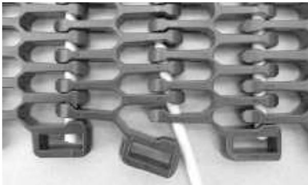
**Figure 311:** Insérez l'axe à travers les charnières
