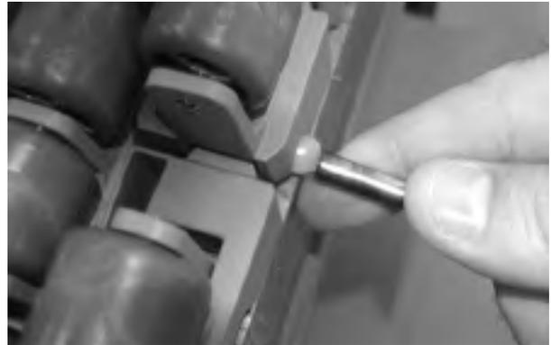
Figure 185: insérez l'axe dans le système de rétention
