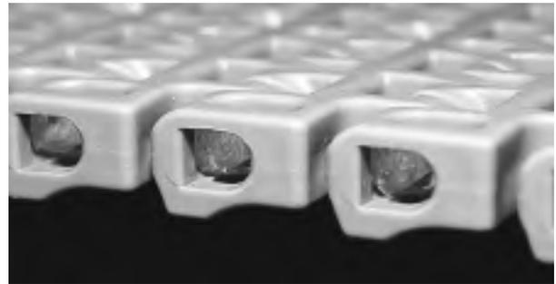
**Figure 141:** Vérifiez que l'axe est inséré au-delà du système de rétention
