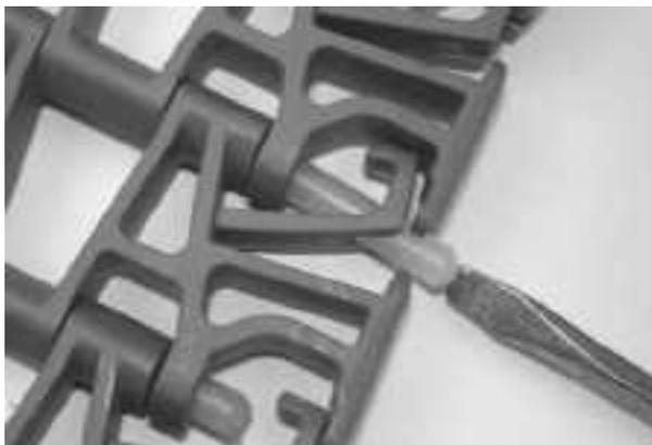
**Figure 235:** insérez l'axe dans le système de rétention
