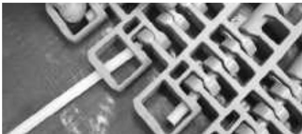
Figure 325: Insérez l'axe à travers les charnières
