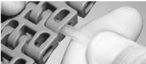
**Figure 130:** Insertion de l'axe à travers les charnières
