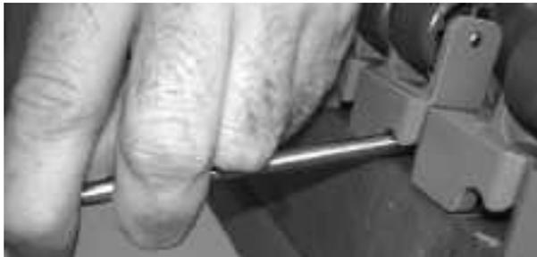
Figure 188: Insérez l'axe en acier dans la charnière
