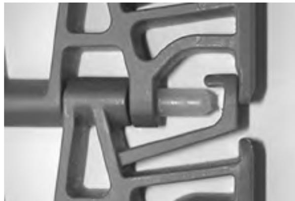
**Figure 236:** Vérifiez que l'axe est inséré au-delà du système de rétention
