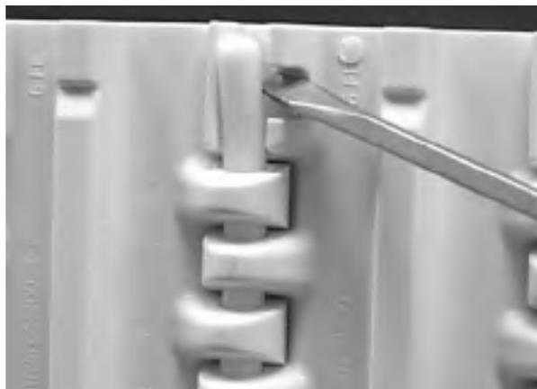
**Figure 201:** Soulevez l'axe au-dessus du système de rétention
