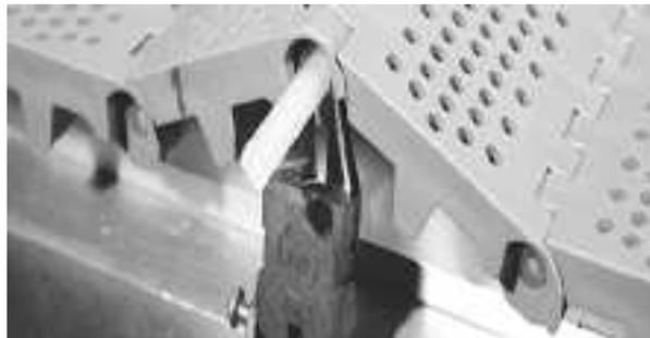
Figure 60: Coupez l'extrémité de l'axe en alignement avec le bord du tapis
