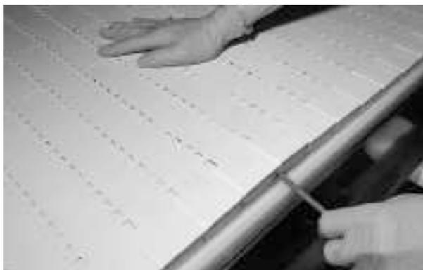
**Figure 84:** Insérez l'axe à travers les charnières jusqu'à ce qu'il soit bien en place
