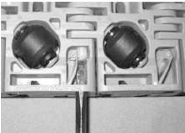
**Figure 213:** insérez l'axe dans le système de rétention
