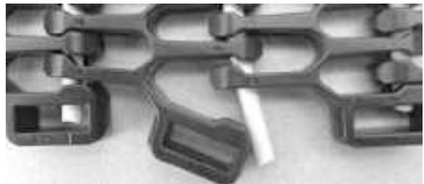
**Figure 313:** Enfoncez l'axe au-delà du bord du tapis
