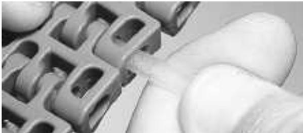
**Figure 139:** Insérez l'axe à travers les charnières
