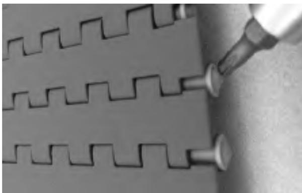
**Figure 127:** insérez l'axe dans le système de rétention
