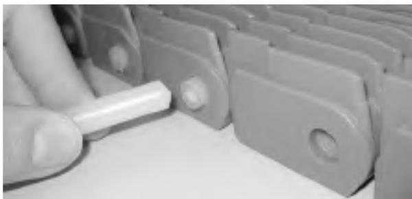
**Figure 204:** Poussez l'axe au-delà du Shuttleplug
