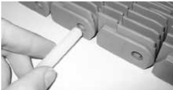
**Figure 203:** Insérez l'axe à travers les charnières
