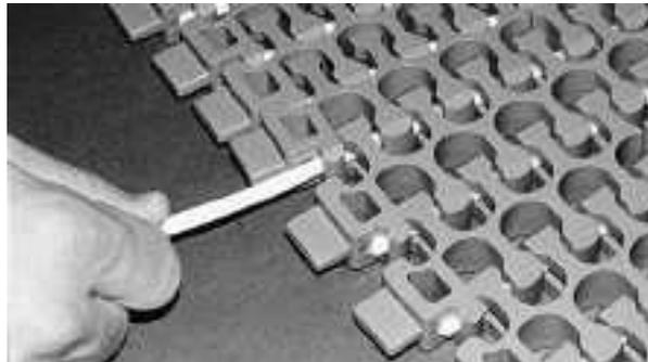
Figure 258: Insérez l'axe
