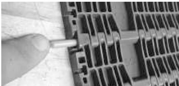
**Figure 254:** Insérez l'axe
