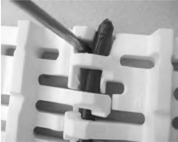
**Figure 77:** Insérez l'axe au-delà du système de rétention
