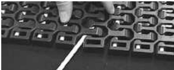
Figure 292: Insérez l'axe à travers les charnières
