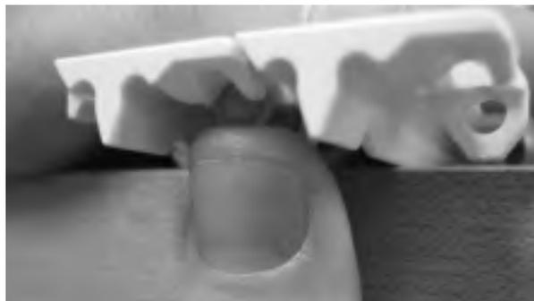
**Figure 175:** insérez l'axe dans le système de rétention
