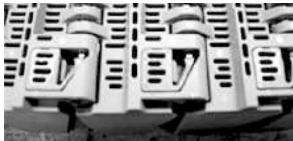
**Figure 100:** Assurez-vous que le système de rétention est fermé
