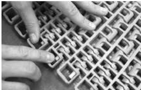
Figure 327: Vérifiez que l'axe est inséré au-delà du système de rétention
