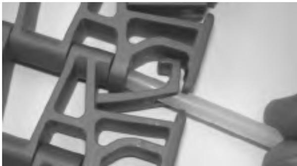
**Figure 234:** Insérez l'axe à travers les charnières
