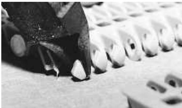
**Figure 27:** Coupez l'extrémité du cône d'espacement
