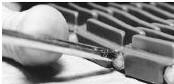
Figure 107: Vérifiez que l'axe va au-delà du clip d'arrêt
