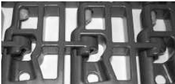
**Figure 111:** Les axes se déplacent à l'intérieur du bord lisse
