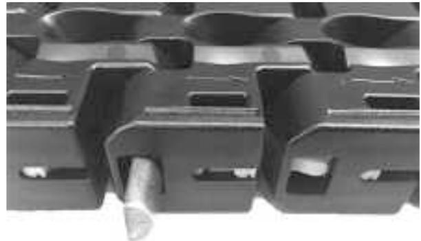
**Figure 194:** Insérez l'axe
