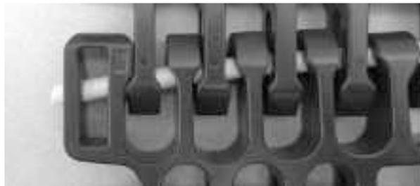
**Figure 302:** insérez l'axe dans le système de rétention
